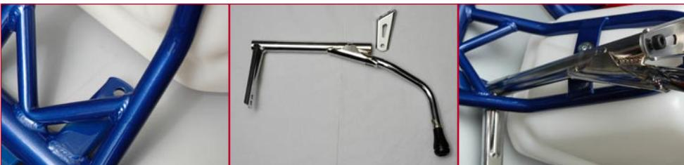
**LA SEQUENZA DELLE MODIFICHE DA KF A KZ** Sopra, a sinistra, il telaio KF con gli agganci che lo "trasformano" in un telaio per kart a marce. In mezzo, la leva del cambio e, a destra, il supporto montato sulla scocca. In basso, il kart della Chiesa Corse.
